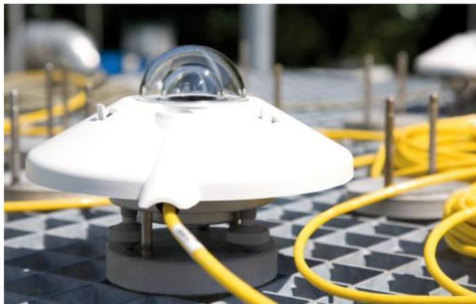
Figura 35. Piranómetro Kipp-Zonen usado de referencia en la industria
